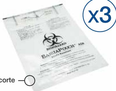
Tres **Envases Secundarios Flexibles**, se trata de bolsas de seguridad fabricadas en poliéster, con autocierre de adhesivo tecnológico y con laterales y fondo termosellados para garantizar la resistencia a la **presión de 95 kPa**. Sin fugas. Con un precorte en un lateral para su fácil apertura, y además disponen de un bolsillo para la documentación. **Sus medidas 250 x 185 mm** permiten albergar botes de orina, placas de Petri o tubos de muestras.
